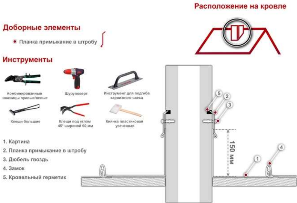
Рисунок 4. Конструкция обхода дымоходной трубы
